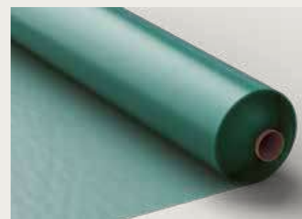
PELÍCULA DE PE (POLIETILENO) 12,5 × 2,7 m = 33,75 m 2 /rollo. Protege al suelo de la humedad que emerge de una solera mineral o de hormigón. 50 años de vida útil. Grosor: 0,2 mm. Material: polietileno, resistente a sustancias alcalinas.
